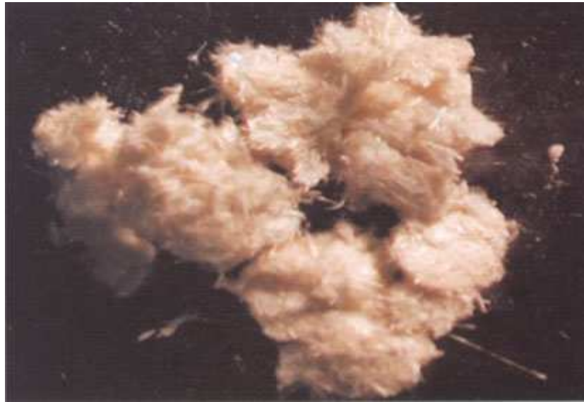
Muestra de amianto ( antofilita )
