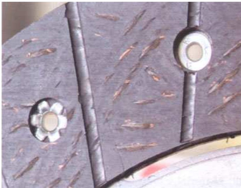
Disco embrague, detalle de la superficie de fricción.
