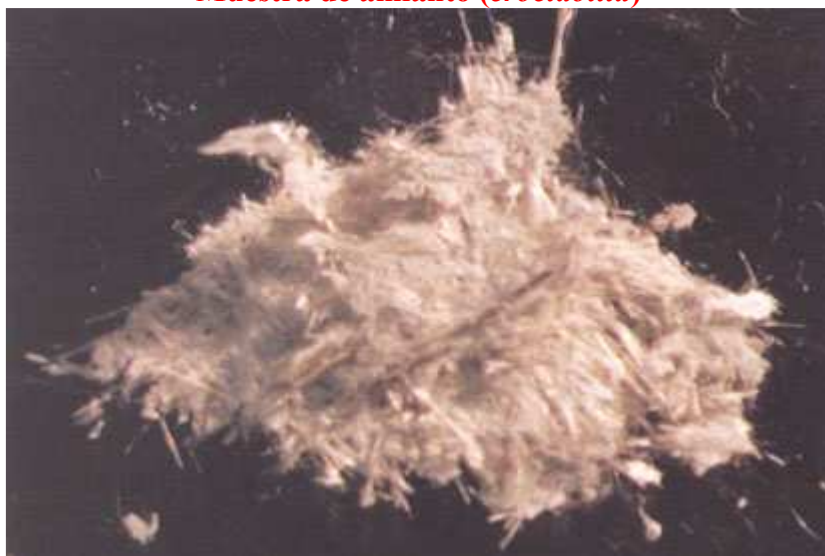
Muestra de amianto ( amosita )
