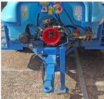
Figura 6. Pie de apoyo en un atomizador.
