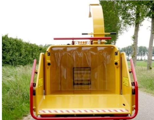
**Figura 7.** Ejemplo de dispositivo de protección (tiras de goma) en conducto de alimentación (Imagen cedida por Vermeer).
