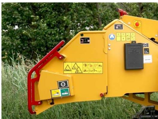
**Figura 9.** Ejemplo de mandos de los componentes de alimentación y de los dispositivos de protección, parada superior y parada de emergencia (Imagen cedida por Vermeer).
